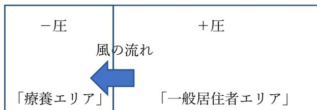
図2 エリア毎の圧と風(空気)の流れ
