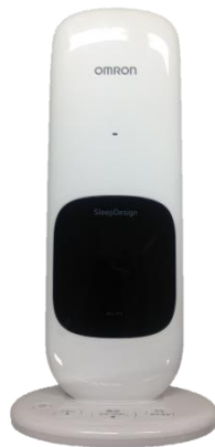
図2-1 使用した睡眠計（睡眠計HSL-101）
