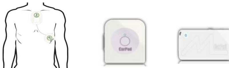
図 3. I -5 CarPod（左：装着位置 中央：送信機 右：受信機）
