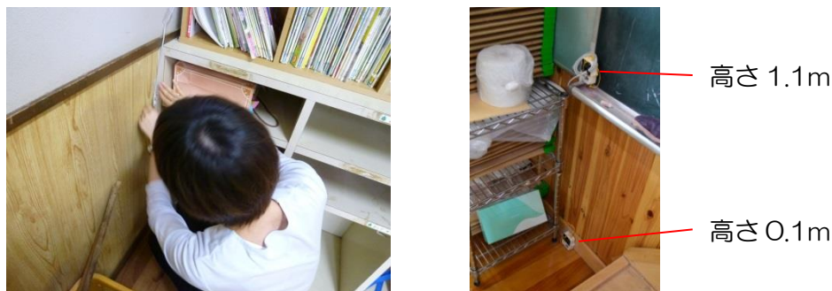
図 4-2 温湿度計設置の様子
